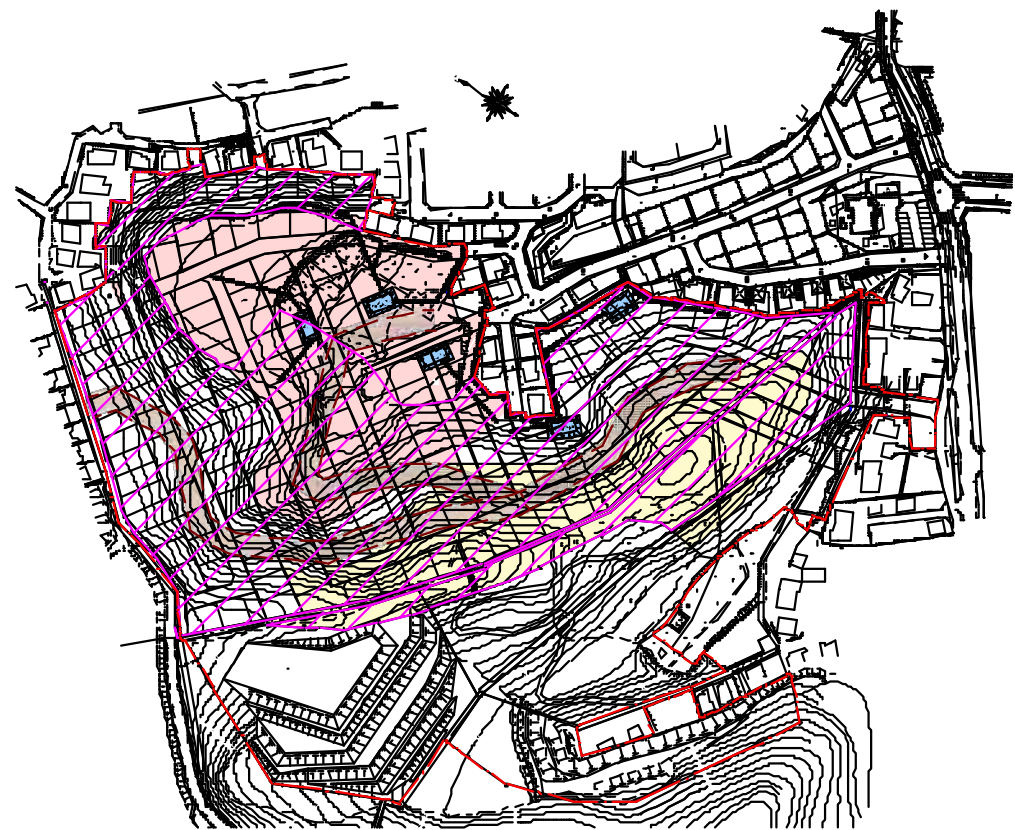
ステップ1 着手から6か月まで 事業区域内伐採工事 事業区域内仮設通路設置工事 刃植物移設作業 切盛土工事（GH165mの高さまで切盛土）
