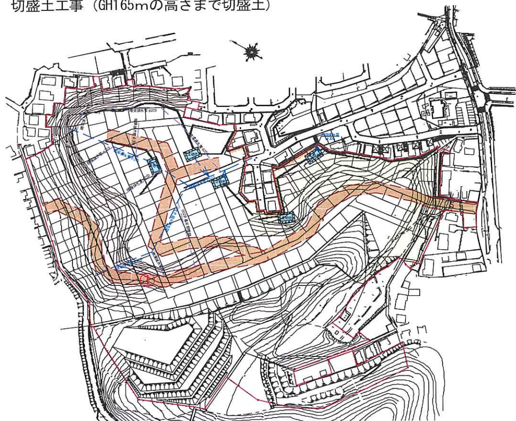
ステップ2 6か月1から11か月まで 事業区域内仮設通路延伸工事 切盛土工事 (GH173mの高さまで盛土)
