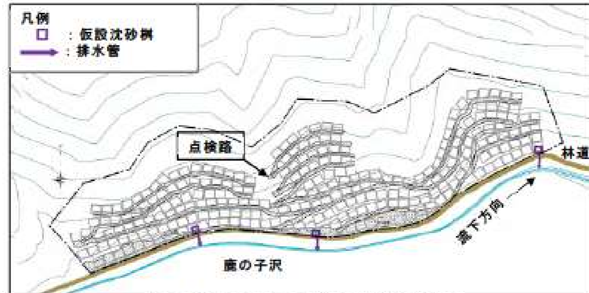
図 4.6-7 工事中の仮設沈砂槽設置位置図
