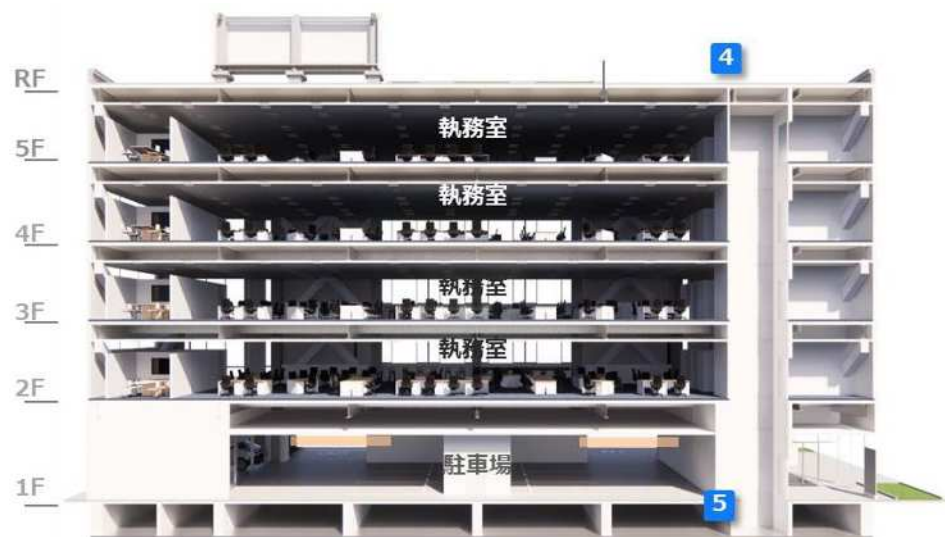
地下ピットに雨水流出抑制槽
