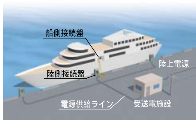
< 陸上電力供給設備イメージ >
