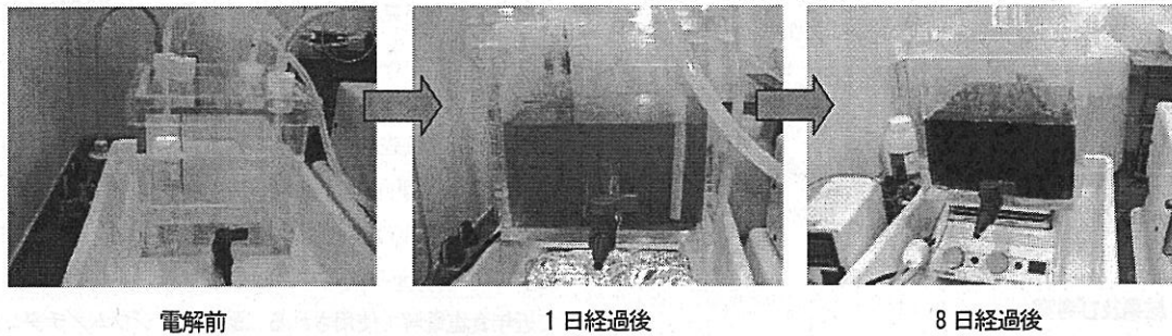
写真 1 黒鉛電極を用いた食塩電解時における陽極液の様子
