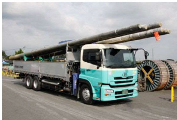
長尺物（CP柱・鋼管柱）輸送
