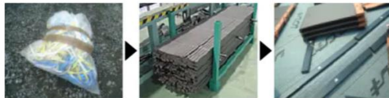
廃梱包材（ポリプロピレン）を瓦葺きの原料として使用
