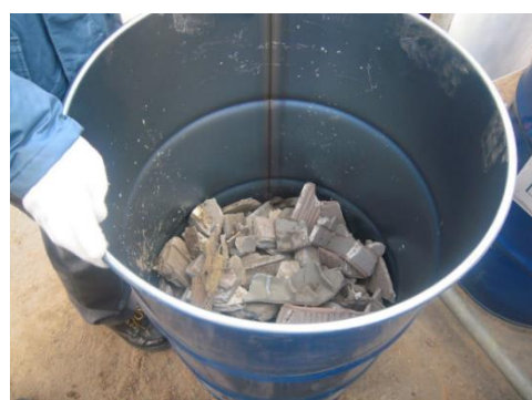
混合廃棄物の状態から仮置場で分別したアスベスト含有のおそれのある建材 (東日本大震災(岩手県宮古市))
