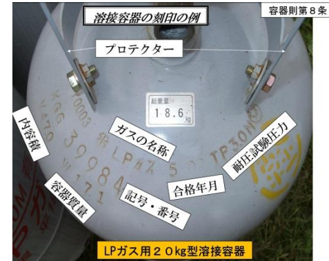
高圧ガス保安法対象容器の刻印、塗装 (一社)兵庫県LPガス協会HPより
