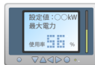
デマンド監視装置による「見える化」
