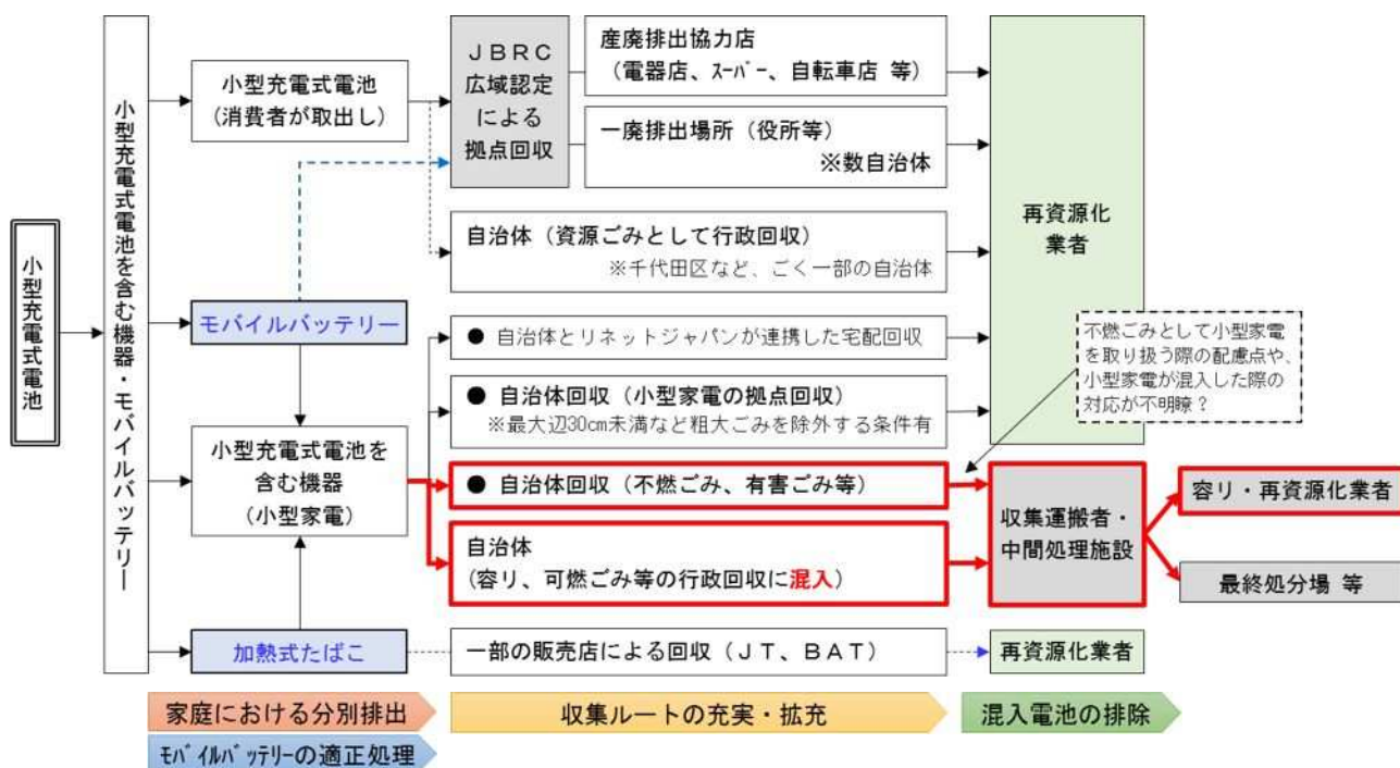
＜図表6 リチウムイオン電池など小型充電式電池及びその含有製品の処理フロー＞
