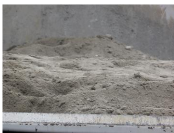
建設泥土改良土
