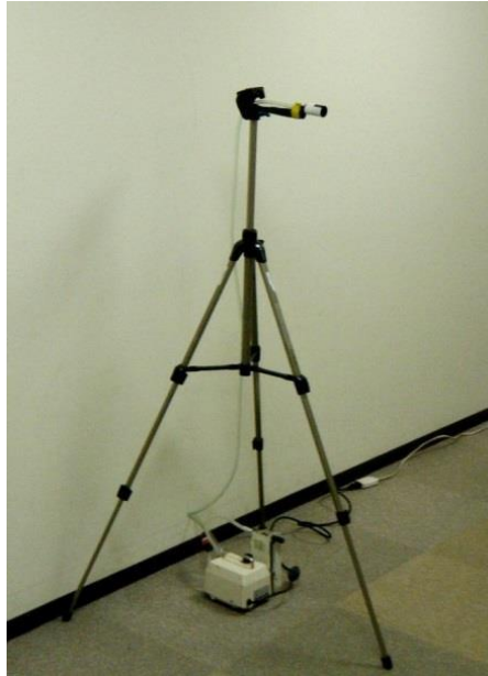
写真 20 空気中の石綿濃度測定
